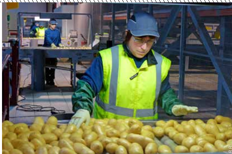
Malgré un passage sous deux trieurs optiques, les pommes de terre subissent un dernier examen manuel avant d'être conditionnées : la qualité avant tout!
